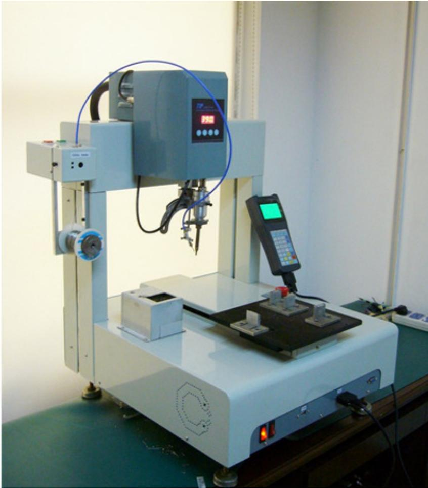
焊锡机器人主要针对人工焊锡很难达到的工艺制程，特别是 **SMT** 后段焊锡工艺中对温度敏感的电子元件焊接、以及因遇热敏感而无法通过回流焊机的元器件、小 **PITCH** 的 **DIP** 封装元器件、连接器 (**CONNECTOR**)、排线、细小的 **CABLE**、喇叭和马达等。
