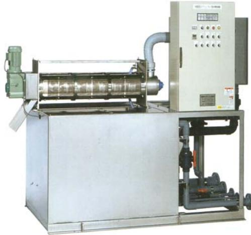
污泥是经过设置于污泥槽内的污泥移送泵（非附件）运至污泥给料箱，污泥在给料箱内由搅拌泵将浓度调制均匀后，再经供给泵传输至计量箱。根据计量箱使污泥按设定好的定量，自然流入到絮凝混合箱中，供给过量的污泥将被自动返送到给料箱。在絮凝混合箱中，使污泥进行适当的絮凝后，供给到污泥脱水机，再经连续浓缩、脱水后，把泥饼排出机外。絮凝剂可从无机絮凝剂和2种高分子絮凝剂的组合（①高分子1液 ②无机+高分子1液 ③高分子2液）中选取，可应对各种性质的污泥。各种絮凝剂将被注入到不同的箱内，其中无机絮凝剂注入到给料箱内，高分子絮凝剂1注入到计量箱出口侧，高分子絮凝剂2注入到混合箱内。另外，通过使用高分子絮凝剂溶解装置，可以实现脱水机的自动连续运转。
