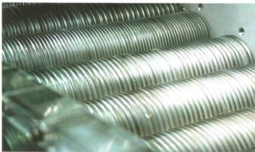
箱型主机内配置了上下2排的“滤体”。该“滤体”被固定定在主轴上，由薄型的不锈钢圆板叠加而成。因为圆板的形状，污泥进入侧称为“过滤部滤体”，泥饼排出侧，称为“脱水部滤体”。
