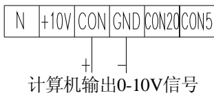
图 13: 计算机0-10V控制的接法
