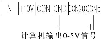
图 16: 0~5V控制的接法
