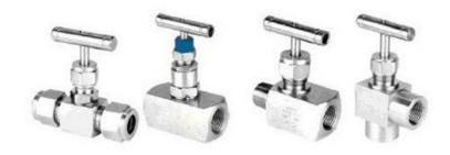
承压范围: 0-40MPA 工作温度: -30-+180℃ 材质: 304、316. 连接方式: 卡套、焊接、内螺纹等 螺纹接口: M20、NPT1/2、NPT1/4等。
