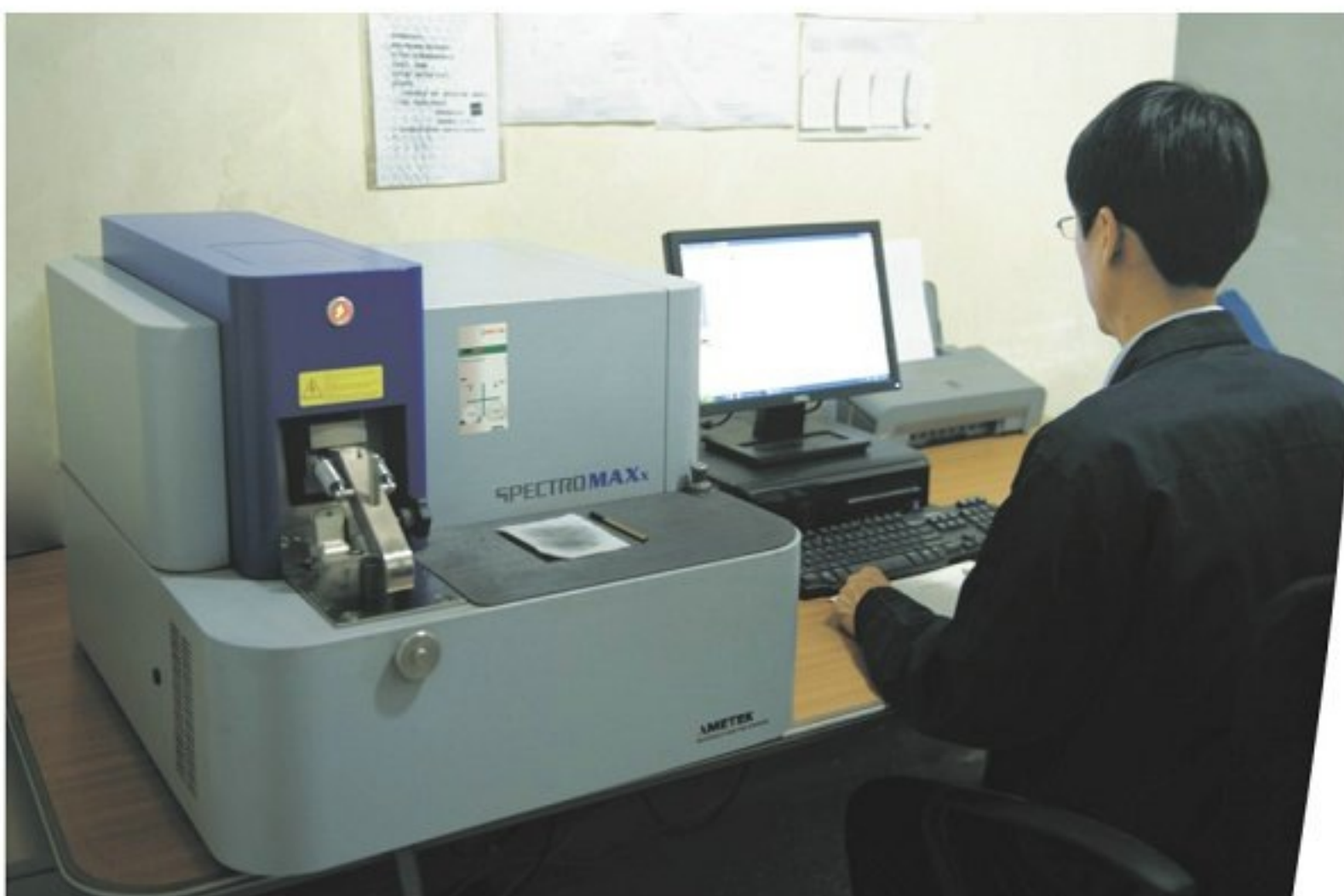
■ 材质分析-德国斯派克光谱仪 SPECTROMAX Meter, Germany
