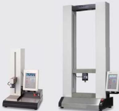
ゴムなどの引張試験や、フィルム、パッケージなどの強度試験や、荷重測定を重視する試験に適しています。
