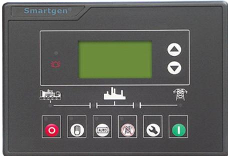
功能特点：采用智能控制器；大屏幕液晶显示器；全中文（也可英文）操作、显示菜单；机组具有自动、手动、关机（急停）等控制功能，丰富的可编程输出、输入接口及人性化界面，多功能液晶显示器，将检测的参数通过数据、符号、直条图显同时显示；标准的通讯接口：RS-232（Modbus 通讯协议），满足用户通过通讯（网络）或中央监控系统（上位机）对机组实现“遥控”、“遥测”、“遥报”等监控功能，可满足各种自动化机组的需要。
