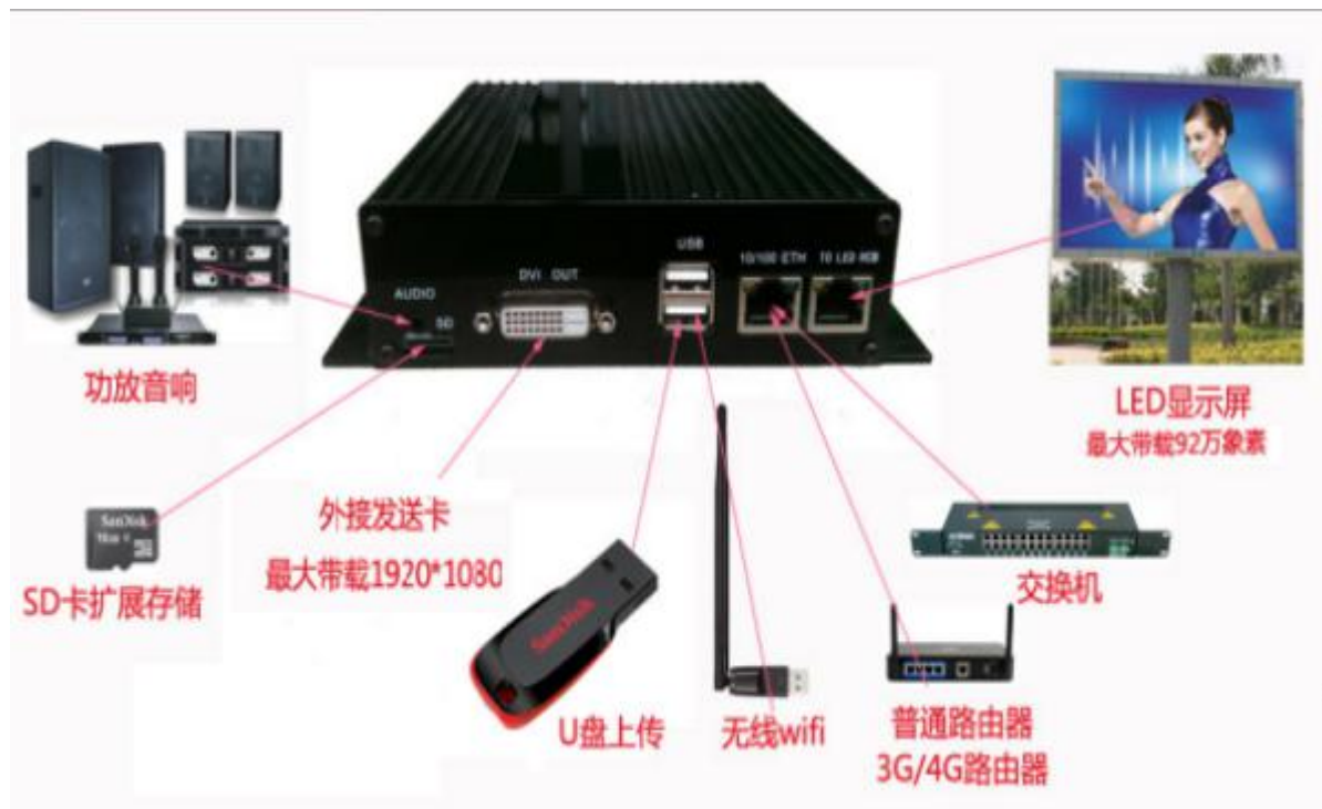
【TX-D1 LED 显示屏媒体播放器拓扑图】
