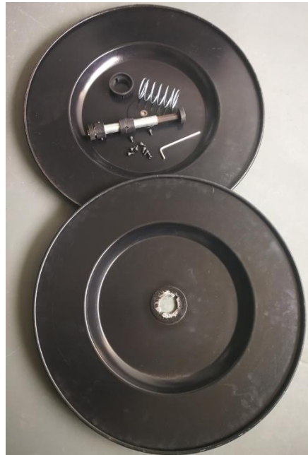
左、右带盘，主轴、压紧弹簧，卡轴、M5螺丝（8枚）、内六角扳手
