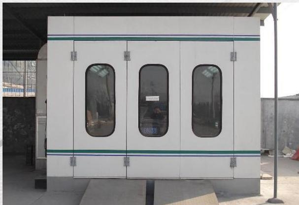
利用低谷电将热能储存，并在日间电价转高时，将储存的热量以热风的方式送入烤箱（烘干室），以实现烤箱快速升温，提高烘烤效率，降低企业运行费用。
