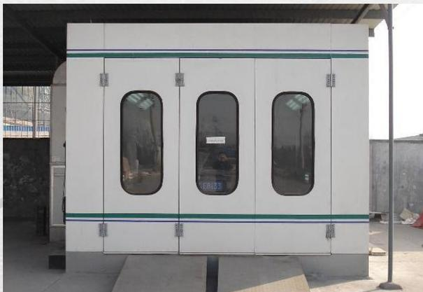
利用低谷电将热能储存，并在日间电价转高时，将储存的热量以热风的方式送入烤箱（烘干室），以实现烤箱快速升温，提高烘烤效率，降低企业运行费用。
