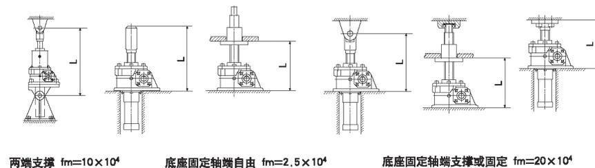
**9 丝杆轴转速校验时，L(L值计算根据各型号尺寸)与fn(支撑系数)选取如下**
