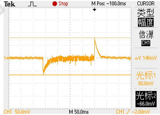
负载瞬态响应 (Vin=CE=5.0V, Iload=0-1.2A)
