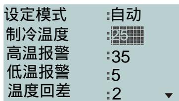
此外，高温报警、低温报警、温度回差的修改请参照上述②制冷温度的修改方法。
