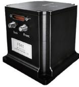
F940 是一款体积仅有 80×80×84mm、重量仅 0.8kg 的小型化光纤惯性组合导航系统。该系统由三轴一体的光纤陀螺、石英加速度计和全系统多频卫星模块组成。
