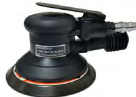
5寸三合一精细磨机 订货号: HR4015 底盘直径: 125mm/6孔 偏心大小: 2.5mm 耗气大小: 200升/分钟 空转转速: 11000r. p. m 磨机重量: 0.84公斤 底漆打磨, 及超精细平面打磨
