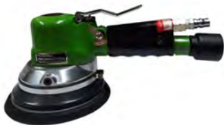
气动6寸铝壳强力打磨机 订货号: HR4004A 底盘直径: 150mm 吸尘孔数: 不规则9孔 偏心大小: 5mm 耗气大小: 400升/分钟 空转转速: 900r. p. m 磨机重量: 2.0公斤
