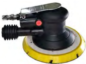
6寸三合一中磨机 订货号: HR4018 底盘直径: 150mm/15孔 偏心大小: 5mm 耗气大小: 200升/分钟 空转转速: 11000r. p. m 磨机重量: 0.85公斤
