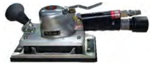
长方型打磨机 订货号: HR4007A 底盘大小: 112X220mm 吸尘孔数: 4+3+4孔 震动轨迹: 5mm 震动频率: 7000b. p. m 耗气大小: 400升/分钟 磨机重量: 2.2公斤
