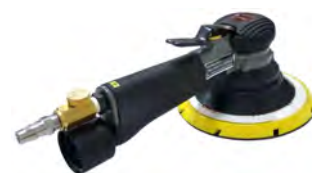
气动大偏心长柄粗磨机 订货号: HR8106A 底盘直径: 150mm/15孔 偏心大小: 10mm 耗气大小: 100升/分钟 空转转速: 12000b. p. m 磨机重量: 1.0公斤 磨机长度: 268mm
