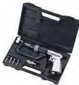
气动焊点定位钻 订货号: JHR3530-2 长度: 284mm 重量: 2.1公斤 耗气大小: 380升/分钟 空转转速: 2000r. p. m 胶盒装, 带2寸定位钩, 5支钻头 微型油雾器, 旋转接头
