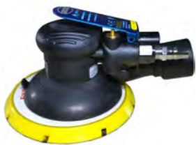
6寸静音型大偏心粗磨机 订货号: HR4021V 底盘直径: 150mm/15孔 偏心大小: 8mm 耗气大小: 60升/分钟 空转转速: 12000r. p. m 磨机重量: 0.73公斤
