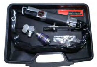
气动汽车切割锯 订货号: HR3526-2 长度: 235mm 重量: 0.54公斤 耗气大小: 200升/分钟 空转转速: 9000r. p. m 往复行程: 10mm 切割能力: 1.5mm以下 胶盒套装, 含24和32齿锯片各5片 排气消音管, 旋转接头, 微型油雾器
