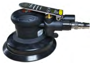
5寸静音中偏心砂光机 订货号: HR8002N 底盘直径: 125mm 偏心大小: 5mm 耗气大小: 60升/分钟 空转转速: 12000r. p. m 磨机重量: 0.7公斤 粘扣400号以下砂纸打磨
