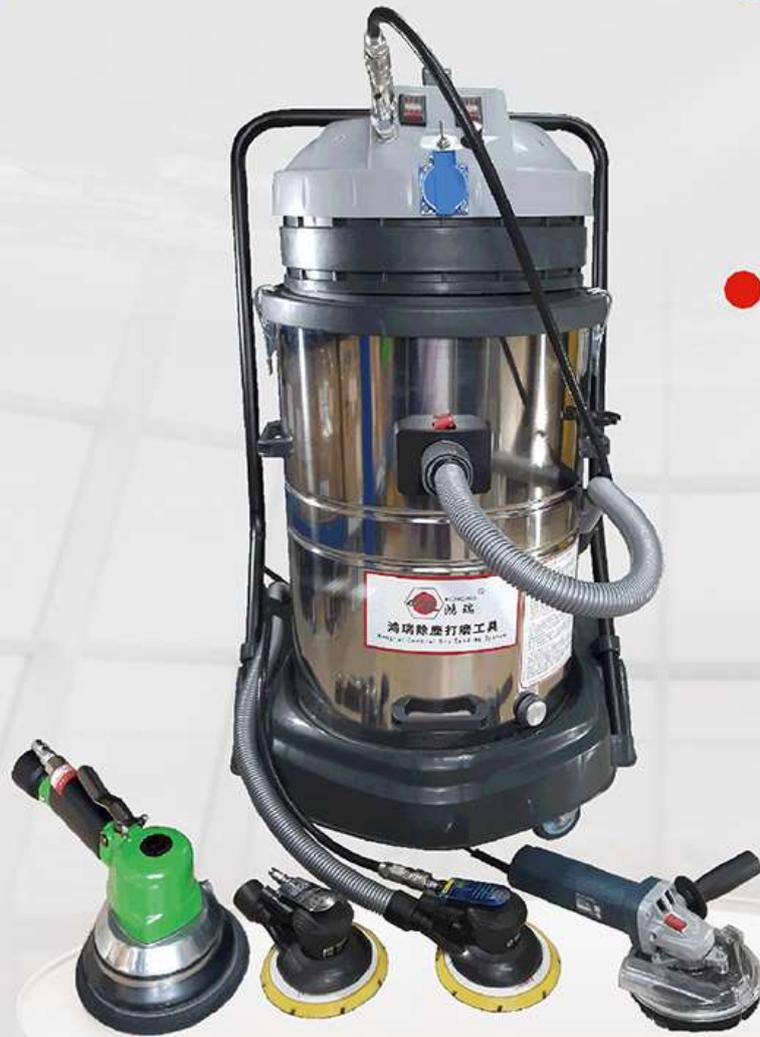
● 电动集尘机有两个专业的高流量工业吸尘电机，可长时间保持高流量真空吸力，确保电动角磨机打磨时有良好吸尘效果，电动角磨机和气动砂纸打磨机都可以自动控制集尘机开机和关机，打磨出来的粉尘直接取到集尘桶粉尘袋内，打磨机停止时电动集尘机延时10-15秒自动停机，吸力大小可以调节，节能省电
