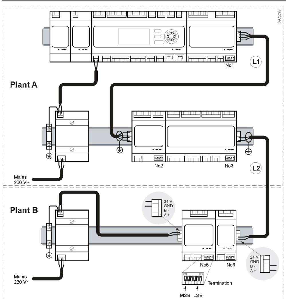
关于供电和设备总线（连接 IO 扩展）的技术要求：
