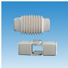
品名：中间连接件 订货号：800.8.130.00 重量：15kg 材料：铸钢 可水平旋转0-180°
