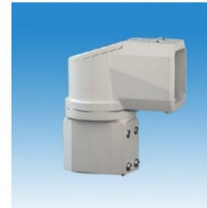
品名：可旋转90°转角 订货号：440.6.190.00 重量：1.32kg 材料：压铸铝合金可水平旋转0-320°
