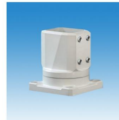
品名：可旋转底座 订货号：440.6.180.00 重量：0.94kg 材料：压铸铝合金可水平旋转0-320°
