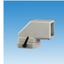
品名：90°箱体连接件 订货号：800.8.150.00 重量：2.5kg 材料：压铸铝合金 可水平旋转0-320°
