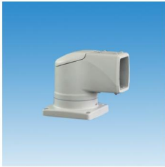
品名：顶座 订货号：550.7.120.00 重量：2.7kg 材料：压铸铝合金 可水平旋转0-320°可限位（请咨询）
