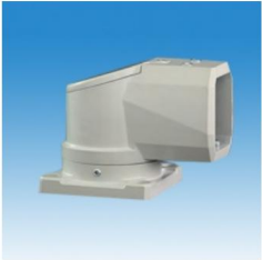
品名：顶座 订货号：440.6.120.00 重量：1.13kg 材料：压铸铝合金可水平旋转0-320°
