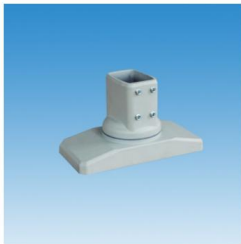
品名：防颤箱座 订货号：550.7.080.00 重量：2.56kg 材料：压铸铝合金
