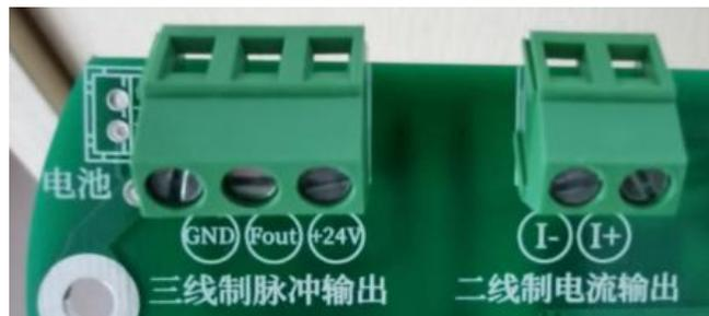
“I+”接+24V 外电源，电流输出从“I-”端流出至计算机或显示表的取样电阻，经过取样电阻等负载后流回到电源“-”端。是两线制 4-20MA 电流输出端。
