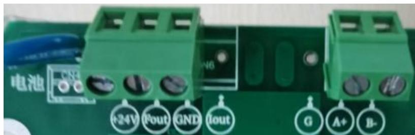
（IOUT 端子处有接线端子的型号可以输出对 GND 端子 4-20MA 电流信号）
