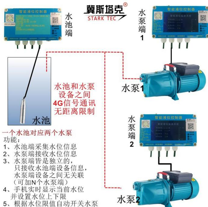
**场景 4:** 一级水池向二级水池供水，水泵在一级水池，一级水池的水打到二级水池，开启水泵的同时需要确保一级水池有水，防止水泵空转损坏水泵；选型：选用一个发送端主机和一个水泵接收端，水池端主机和水泵端主机都连接液位计，水泵端主机测的水位低于设置的下限时禁止开启水泵。
