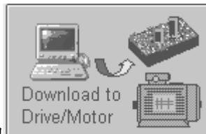
按下 Download to Drive/Motor 按钮，以下载您的设置数据到驱动器/电机的 EEPROM 存储器中，以设置表形式存储。从现在开始，每次上电时该设置数据将被复制到驱动器/电机的 RAM 存储器中供运行期间使用，也可用 Save 将设置数据保存
