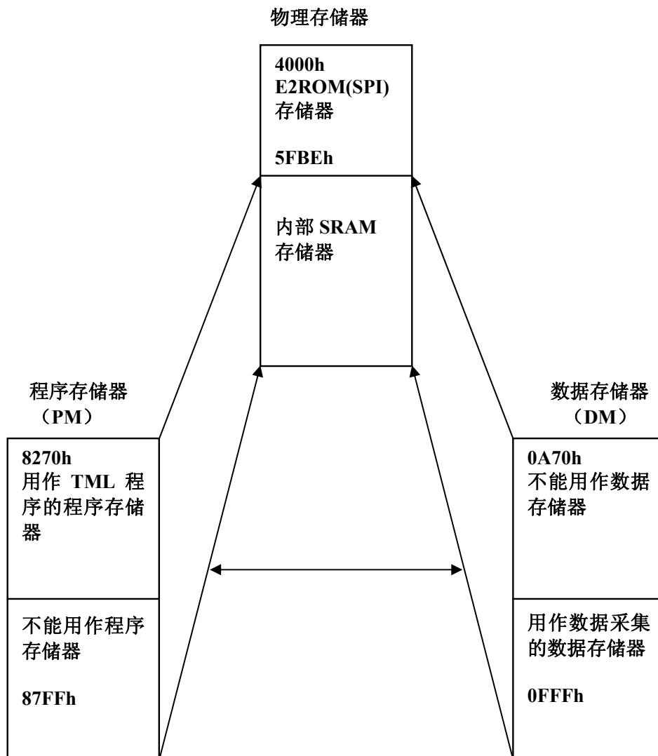
图 7.1. IBL2403A / IBL2403A-RS232/CAN 存储器映射
