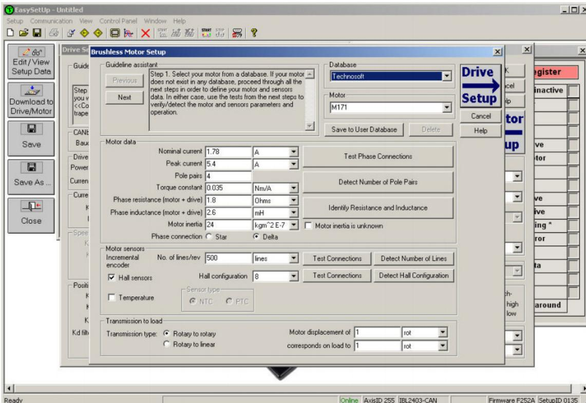
在 Motor Setup 对话框中您可以导入电机和传感器的数据，数据导入后将伴随一系列的测试，目的是检查驱动器的连接及检测或验证电机和传感器的部分参数。在 Drive setup 对话框中，您可以为您的应用配置或参数化驱动器，在每一个对话框中您将找到 Guideline
