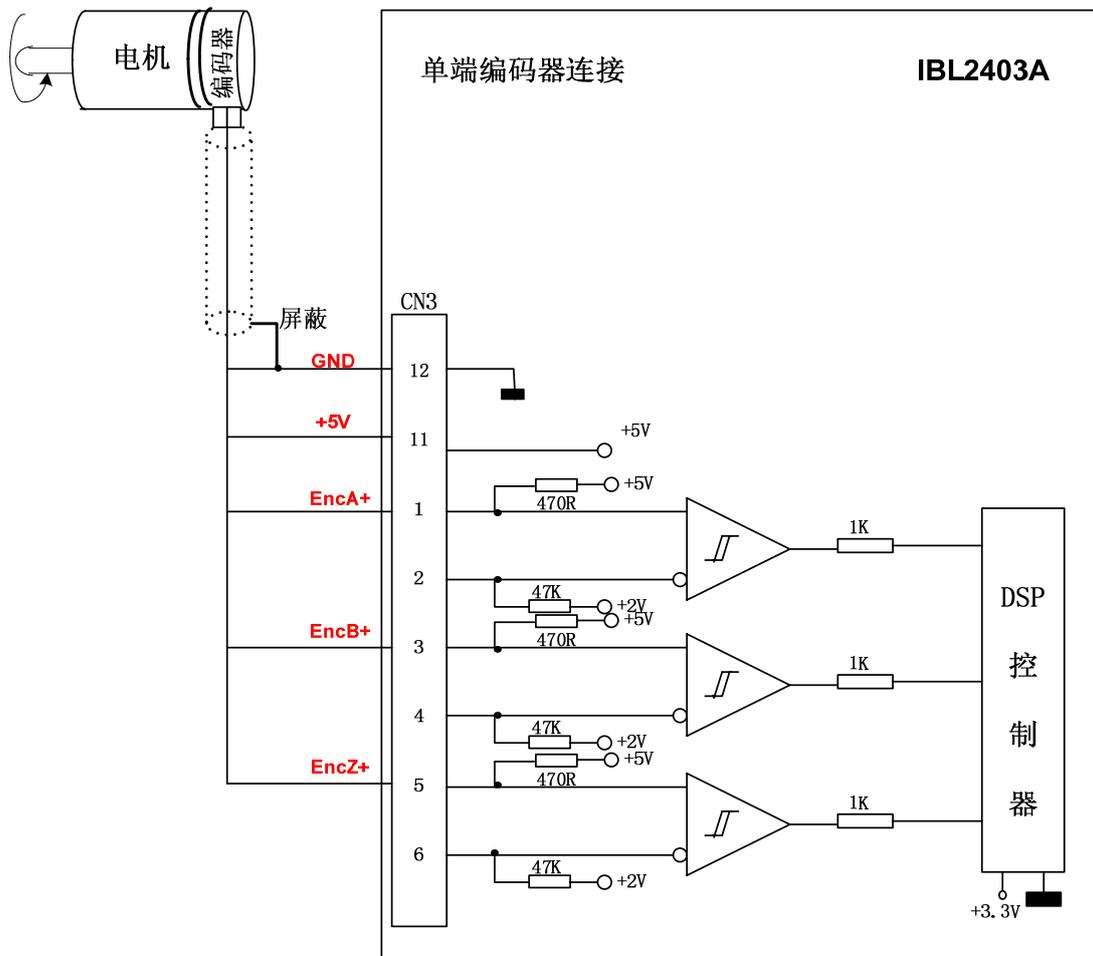
图 3.8. 单端编码器连接
