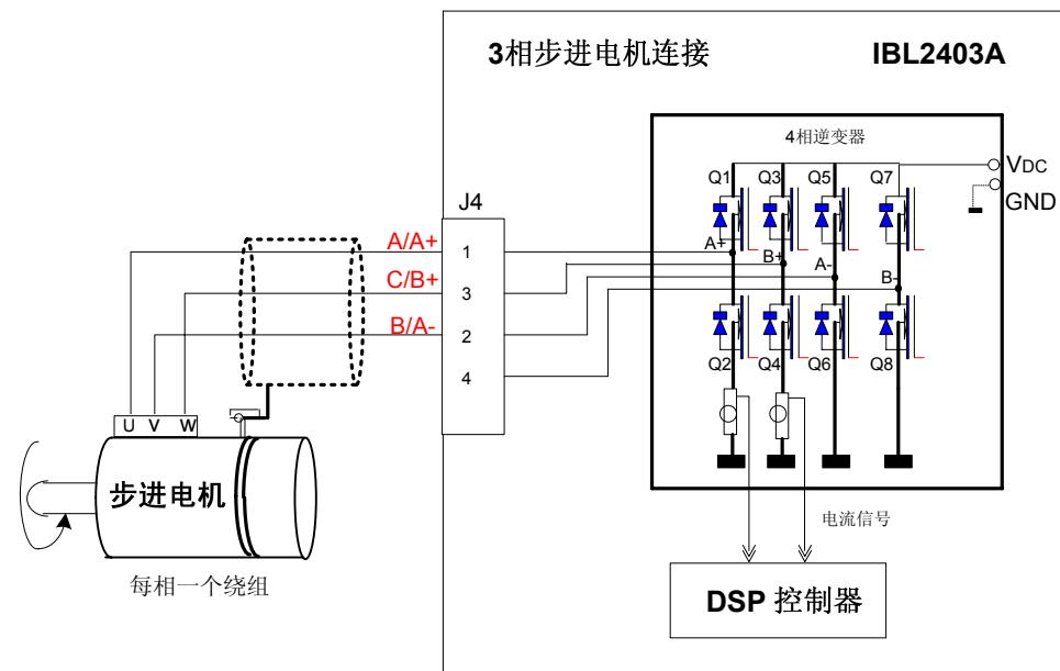
图 3.6. 3 相步进电机连接
