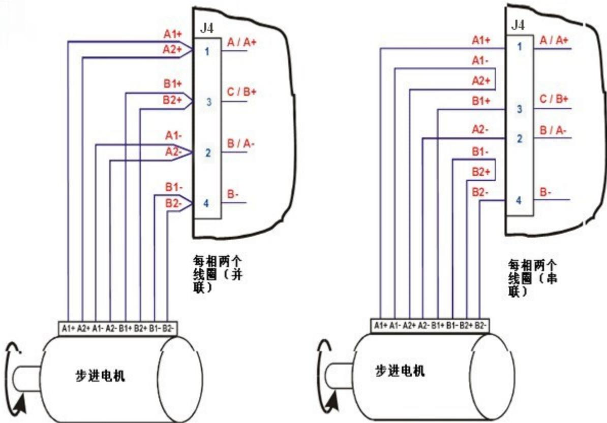
图 3.5. 步进电机连接
