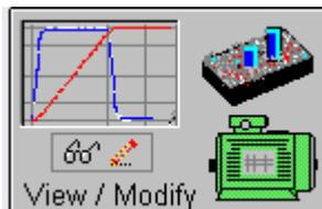
按下 View/Modify 按钮，弹出两个设置对话框：Motor Setup 电机设置和驱动器设置 Drive Setup（与 EasySetUp 一样）通过他们您可以配置和参数化泰科智能驱动器，在 Motor setup 对话框中您可以导入电机和传感器数据，数据导入跟随一系列的测试为检查与电机连接或验证电机和传感器部分参数，在 Drive setup 对话框中，您可以为您的应用配置或参数化驱动器，在每一个对话框中您将找到 Guideline Assistant，它可以在整个导入和检查数据的过程中指导您完成。
