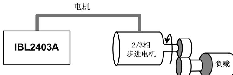
图 2.8 步进电机位置或速度开环控制，无位置或速度反馈传感器
