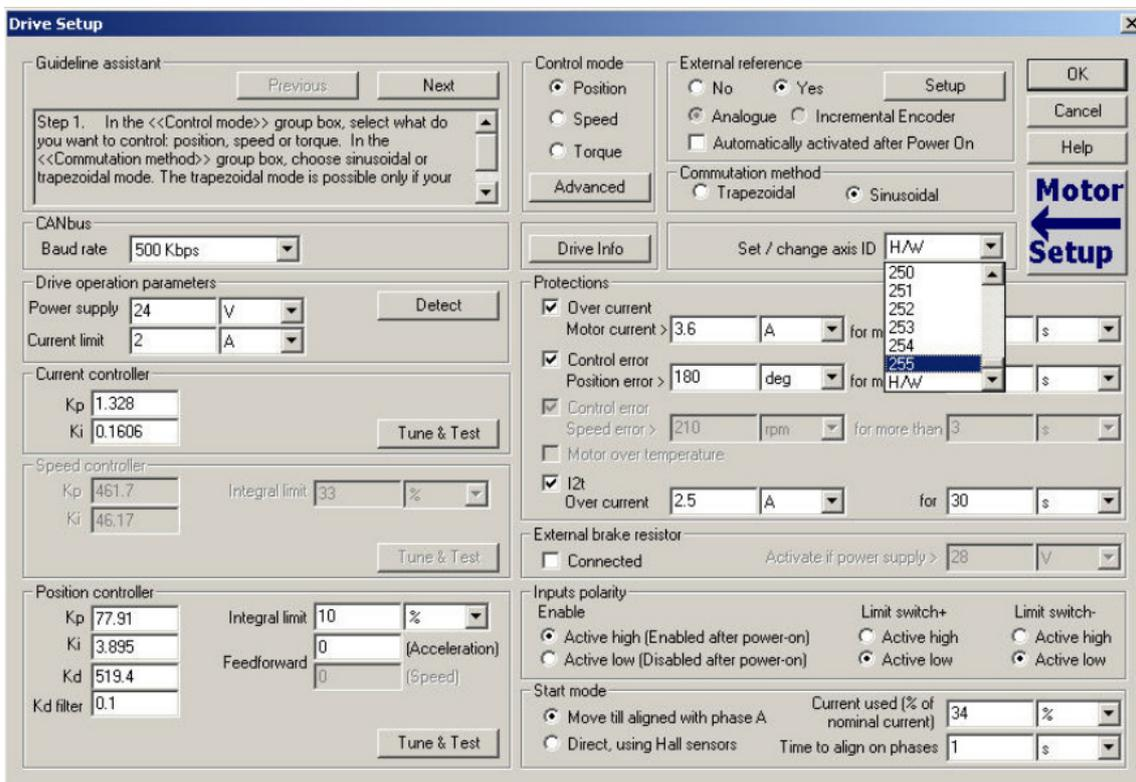
IBL2403A 驱动器轴的 ID 号可以被软件设置—存储在设置表中的 1 到 255 之间的任意一个值。驱动器上电时，轴 ID 号被初始化，用以下算法计算：
