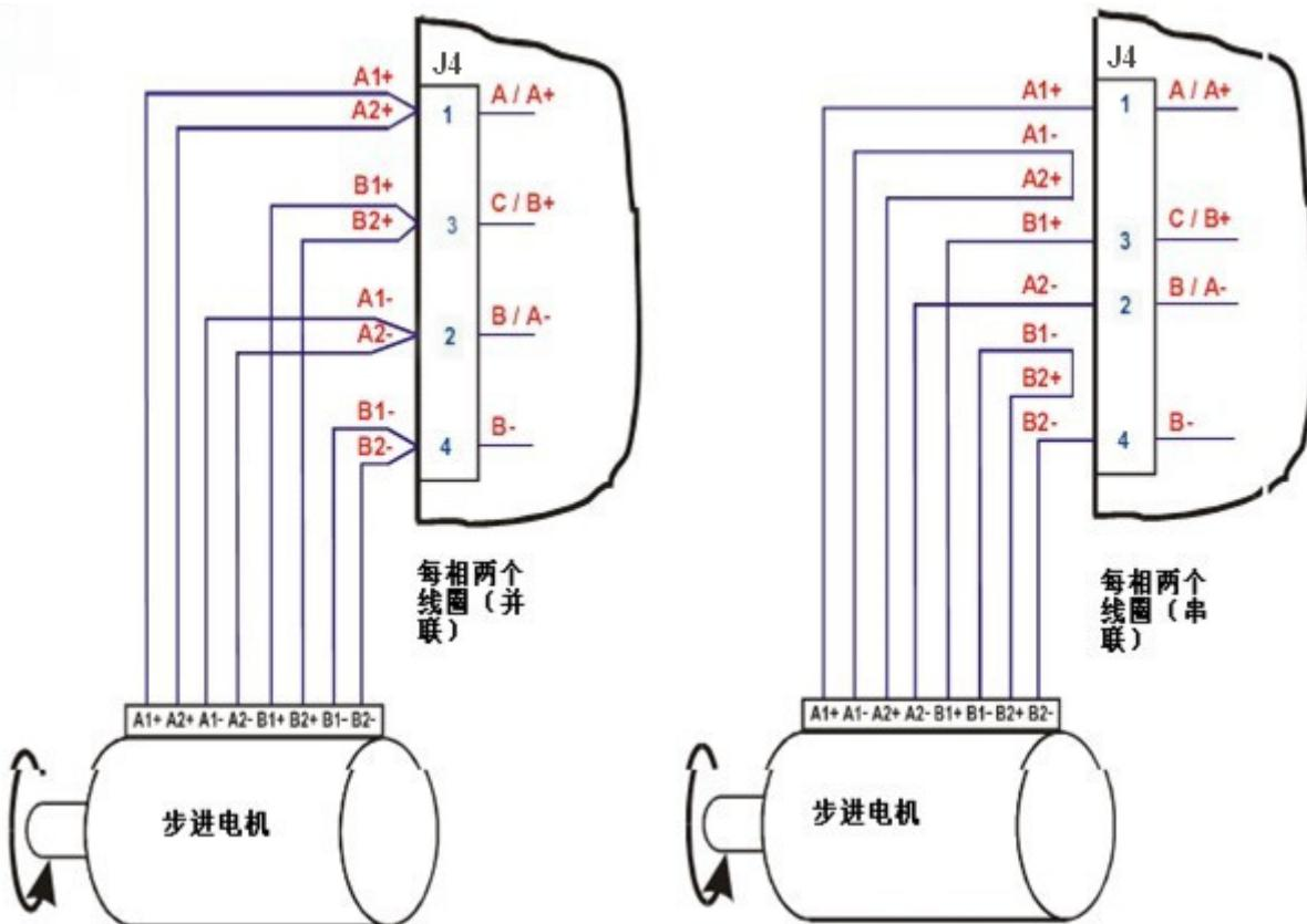
图 3.5. 步进电机连接
