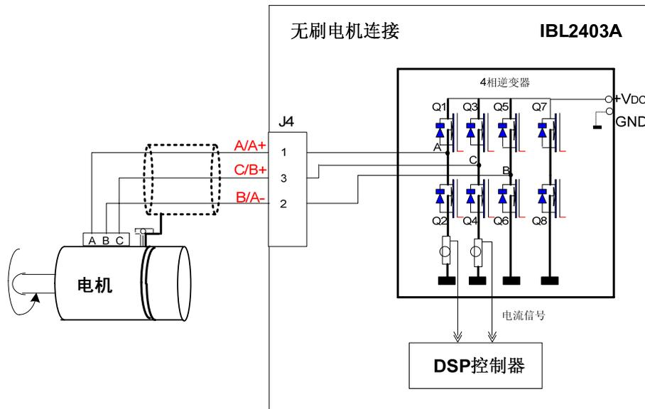
图 3.3. 无刷电机连接
