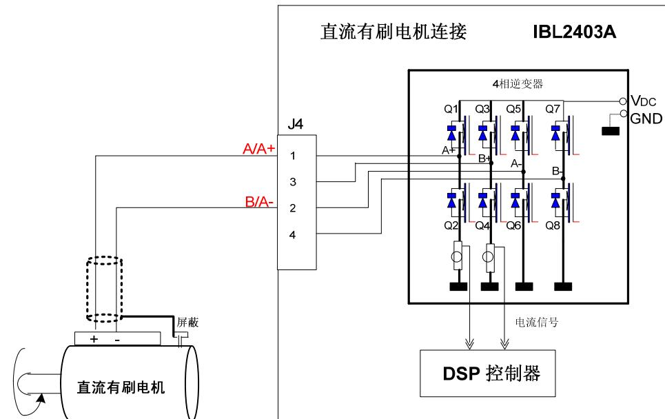
图 3.7. 直流有刷电机连接
