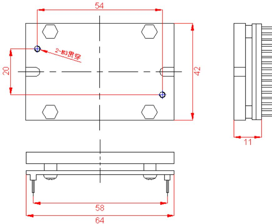
图 2.11. IBL2403A 驱动器尺寸图 (单位: mm)
