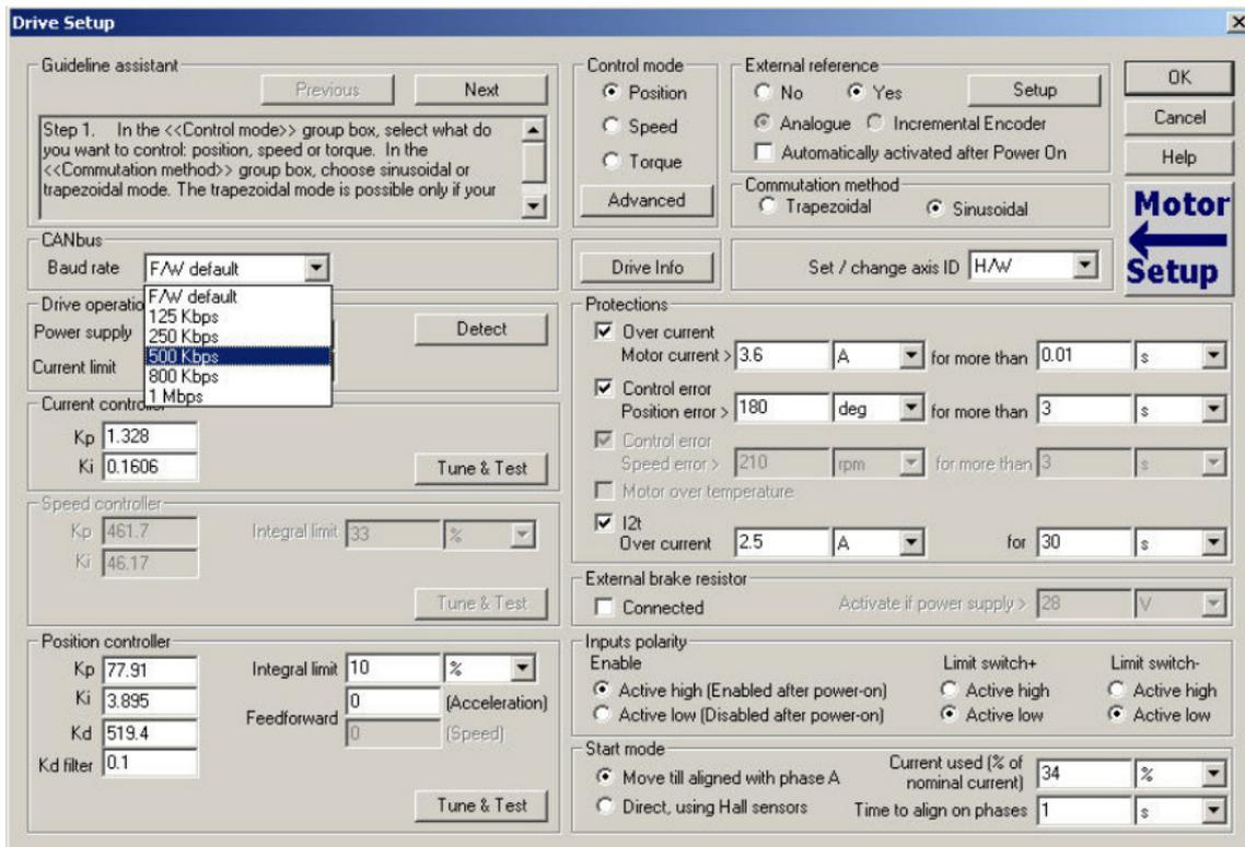
IBL2403A 驱动器在 CAN 通信时能工作在以下波特率：125kHz，250kHz，500kHz，1MHz.。在驱动器设置对话框中您可选择驱动器上电后初始 CAN 波特率，这个信息将存储在驱动器参数设置表中，CAN 波特率根据以下算法来初始化：
