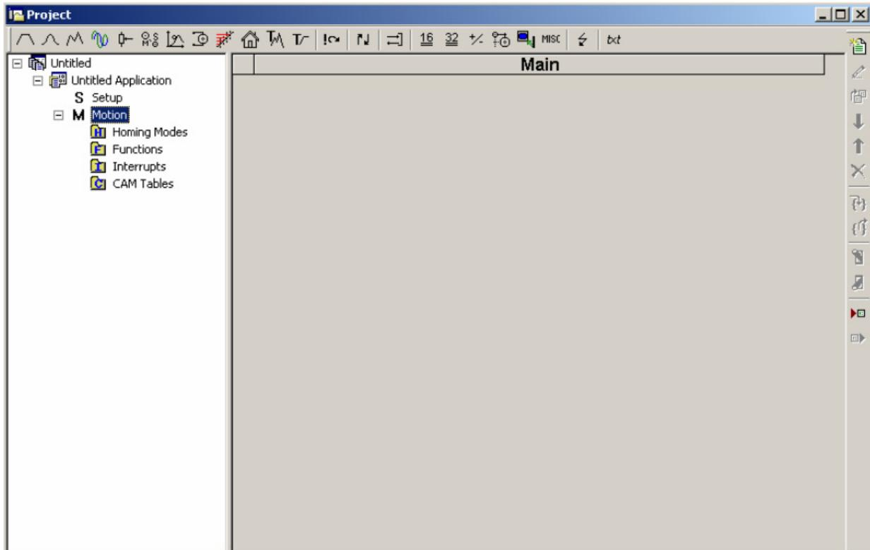
Motion Wizard 提供了用高级图形对话框编程所有运动序列后自动生成相应的 TML 指令，因此运用 Motion Wizard 您无需学习 TML 语言就几乎可以用所有的 TML 指令开发运动程序，一个 TML 程序包含了一个主程序，接下来可用的子程序：函数、中断服务进程（可用户化）和回原点过程程序，TML 程序也包含一个用于电子凸轮应用的凸轮表。
