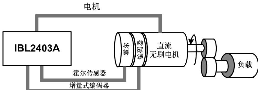
图 2.2. 直流无刷旋转伺服电机, 位置/速度/转矩控制, 电机上带霍尔传感器与增量编码器
