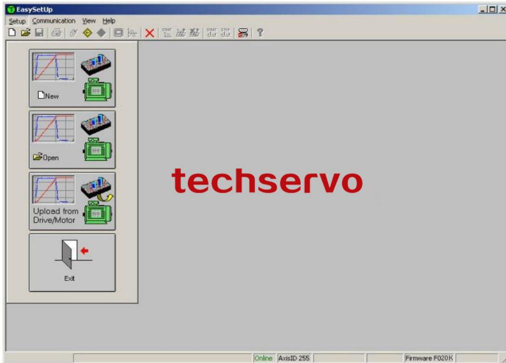
在选择上述任何一个操作前，您必须与您想试运行的驱动器建立通讯，用菜单 **Communication | Setup** 去检查/改变您的 PC 通讯设置，按下对话框中的 **Help** 按钮，这里您能找到关于如何去设置您的驱动器和如何去连接的详细信息，给驱动器上电，然后点击 **OK** 关闭 **Communication | Setup** 对话框，如果建立了通信，在 EasySetUp 的状态栏中（底线）显示“Online”加上驱动器/电机轴的 ID 号和固件版本，否则将显示“Offline”及告诉您错误类型的通讯错误信息，在这种情况下返回 **Communication | Setup** 对话框，按下 **Help** 按钮并且检查故障。
