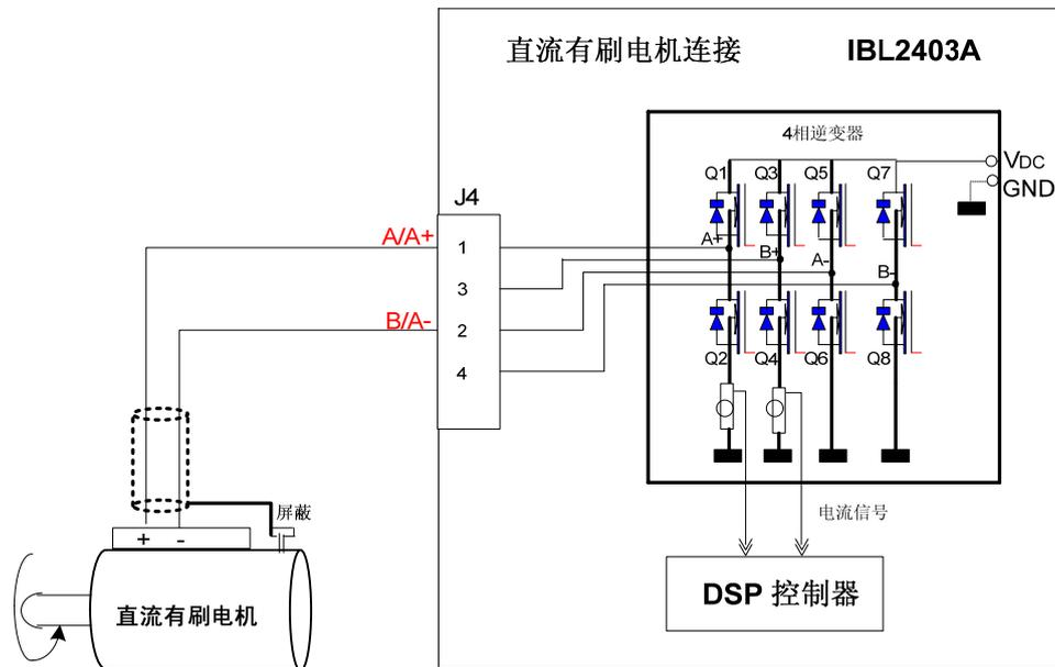
图 3.7. 直流有刷电机连接
