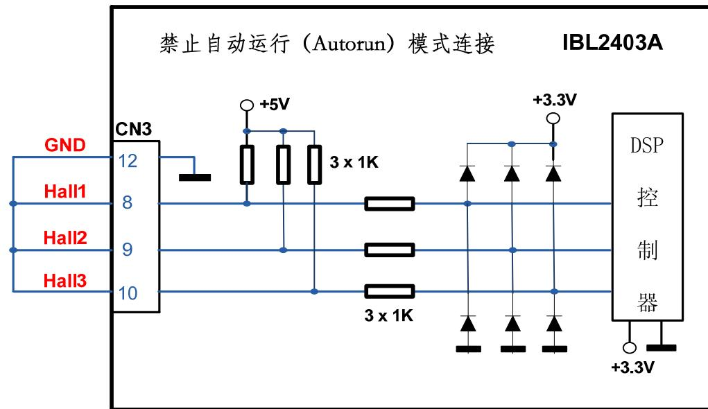
图 3.17. 禁止自动运行 (Autorun) 模式连接
