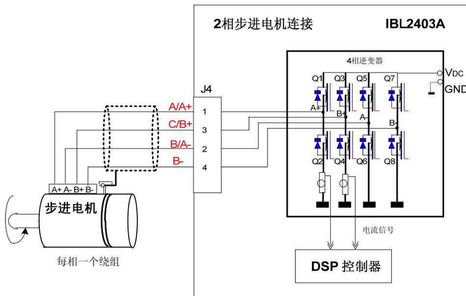
图 3.4. 步进电机连接
