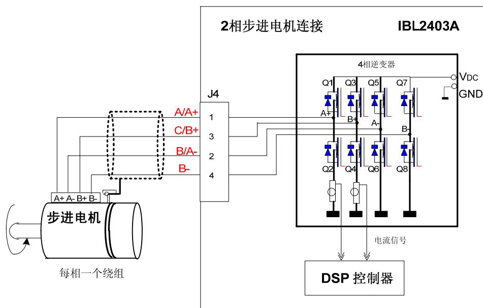
图 3.4. 步进电机连接
