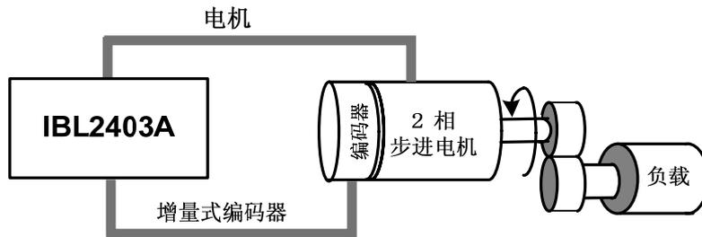
图 2.10. 电机轴上带增量编码器，闭环控制：步进电机位置、速度或转矩
