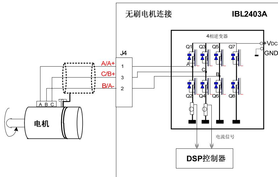
图 3.3. 无刷电机连接
