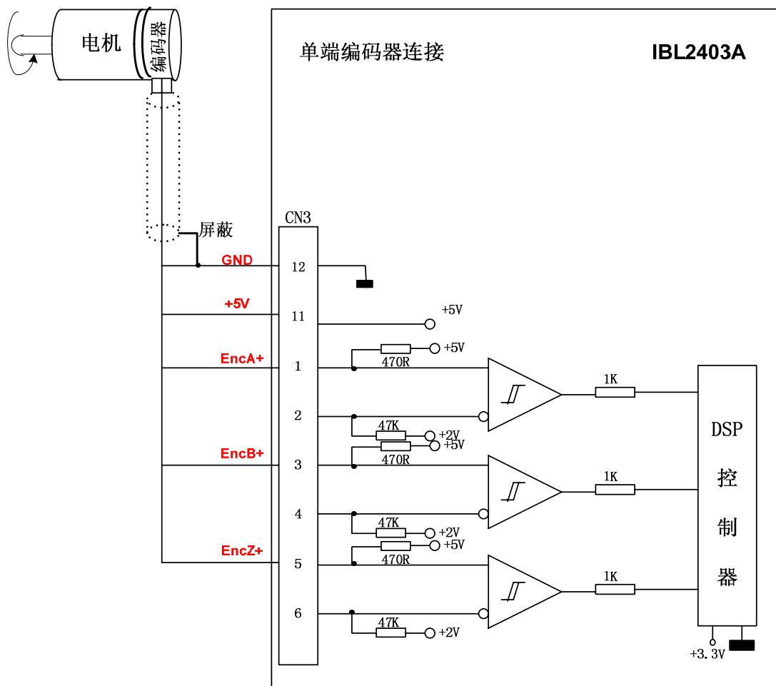
图 3.8. 单端编码器连接
