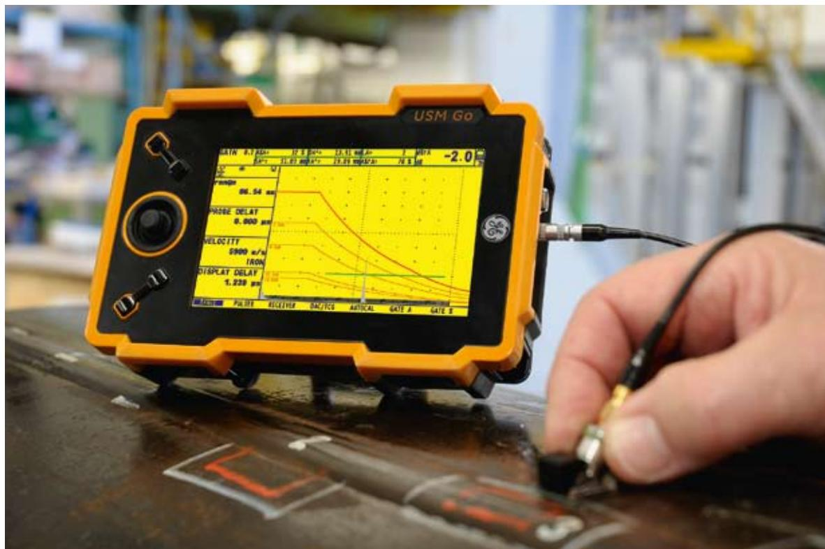
USM Go是GE传感检测科技集团生产的最轻巧便携的超声探伤仪。在油气、航天、电力、以及汽车行业各种苛刻的检测环境下, USM Go的设计使得操作更为简便, 即使是长时间操作也能轻松完成。
